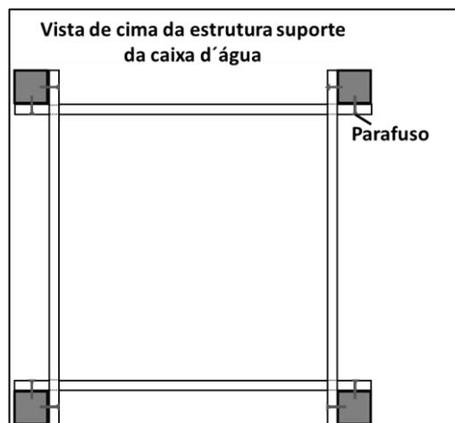
Ainda em relação às estruturas que dão suporte as caixas d'água, a indicação é que os pilares sejam enterrados a 1 metro de profundidade no solo, o que garante um bom atrito e aderência lateral tanto para a estrutura da caixa de 1.000 litros, quanto para a estrutura da caixa de 5.000 litros.
