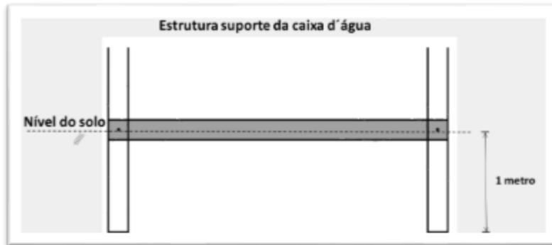
Vale destacar que a estrutura deve ser parafusada nos pilares a fim de garantir a sustentação da força exercida pelo peso da caixa d'água, conforme ilustrado na figura 11.
