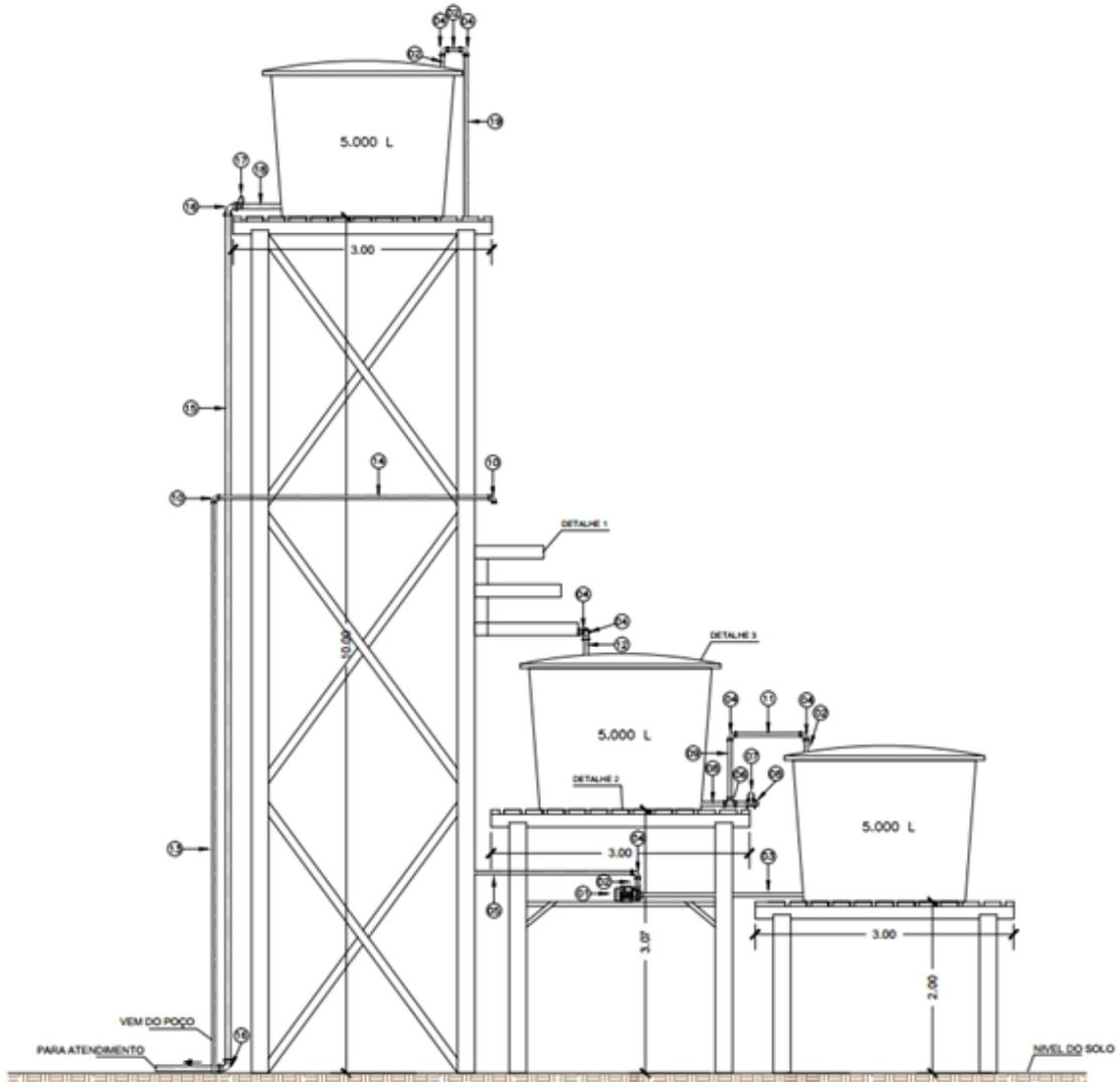
A estrutura que dá suporte a caixa de 5.000 litros deverá ter na sua base uma estrutura quadrada de amarração, a fim de aumentar a área de contato da estrutura com o solo, garantindo uma melhor distribuição do peso da caixa d'água no solo.
