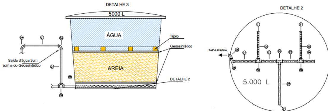
Os geossintéticos são mantas fabricadas pela deposição aleatória de fibras poliméricas (monofilamentos contínuos ou cortados), principalmente poliéster e polipropileno. As principais vantagens proporcionadas pelos geossintéticos como elemento filtrante, em relação a outros meios convencionais, como a areia, estão especificadas abaixo, o que justificou sua escolha como um dos componentes do meio filtrante do filtro de areia:
